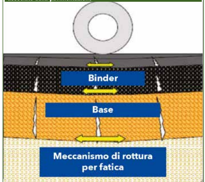
Fessurazione “bottom-up” e stato fessurativo associato della pavimentazione
