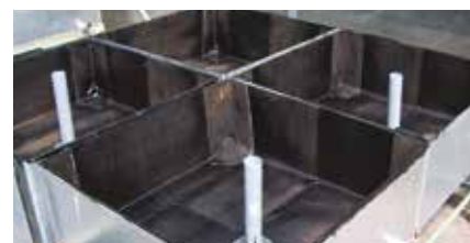
2. Vasche di prova impermeabilizzate
