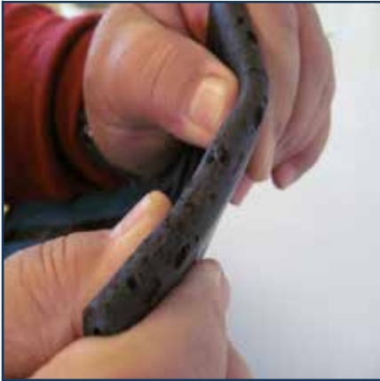
...dopo 1 piegamento screpola
