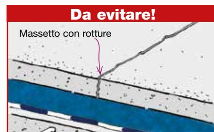
**Stesura del massetto.** Il massetto armato galleggiante è formato da un massetto di allettamento in calcestruzzo armato di spessore non inferiore ai 4 cm di spessore (Quickcem - INDEX).
