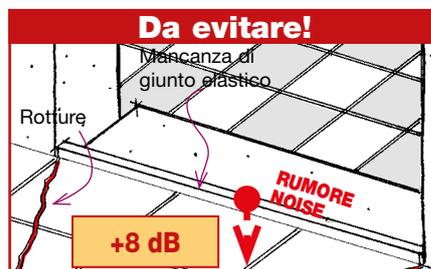
**Giunti di dilatazione.** Prevedere giunti elastici di dilatazione ogni 4-6 m lineari da posizionare preferibilmente in corrispondenza delle soglie. *La mancanza di giunti nel massetto causa la formazione di crepe nel massetto e conseguentemente nella pavimentazione.*
