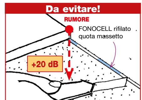
**Posa del battiscopa.** Il battiscopa deve essere posato staccato dalla pavimentazione. *Un eventuale contatto del battiscopa con il pavimento causerebbe un ponte acustico danneggiando la riuscita dell'isolamento acustico nell'entità di 3÷4 dB nel caso in cui il battiscopa fosse in legno, ma addirittura di 20 dB nel caso di contatto tra pavimento e battiscopa ceramico.*
