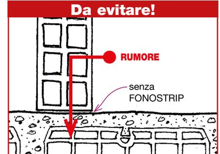
**Isolamento acustico degli impianti.** Fasciare le tubazioni che attraversano il solaio con strisce adesive di materiale elastico. *Un tubo non isolato trasmette il rumore.*
