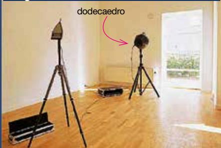
Si noti che rispetto alla prova del calpestio in questo caso si misura con due fonometri una differenza di livello per cui contrariamente al caso suddetto **più elevata è l'isolamento del divisorio più elevata sarà la differenza del rumore fra le due stanze e quindi più alto il potere fonoisolante di questo.**
