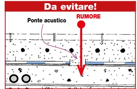
**Sigillatura dei teli.** Sigillare con l'apposito nastro SIGILTAPE le sovrapposizioni laterali e le linee di accostamento con l'apposito nastro adesivo. *Non è assolutamente necessario sfiammare con bruciatore. Una eventuale mancanza di sigillatura può far penetrare la malta cementizia creando un ponte acustico.*
