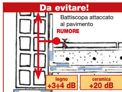
**L'angolo cottura, posa del rivestimento ceramico.** Posare il rivestimento ceramico della parete staccato dalla pavimentazione. *Il contatto rigido del rivestimento con il pavimento causerebbe un ponte acustico che penalizzerebbe l'isolamento fino a 12 dB.*
