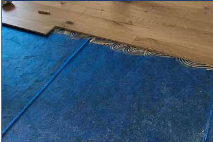
**FONOSTOPTile Monoadhesive e piastrelle incollate con collante FLEXBOND nel test dinamico "Robinson Test" che simula le deformazioni e lo stress a fatica delle pavimentazioni. A destra parquet prefinito incollato con LIGNUM AB. Il campione è stato sottoposto a cicli di usura con carichi 300kg**
