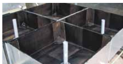
2. Vasche di prova impermeabilizzate
