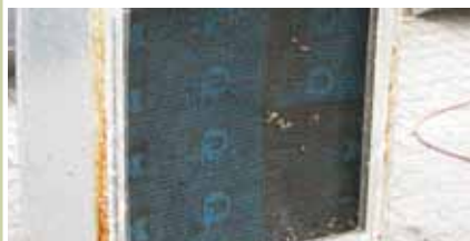
9. Faccia inferiore di DEFEND H inalterata dopo il test
