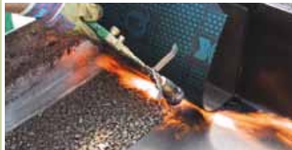
1. Applicazione di DEFEND H nel dispositivo di prova
