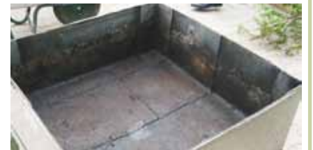
8. Faccia superiore di DEFEND ANTIRADICE/H dopo il test
