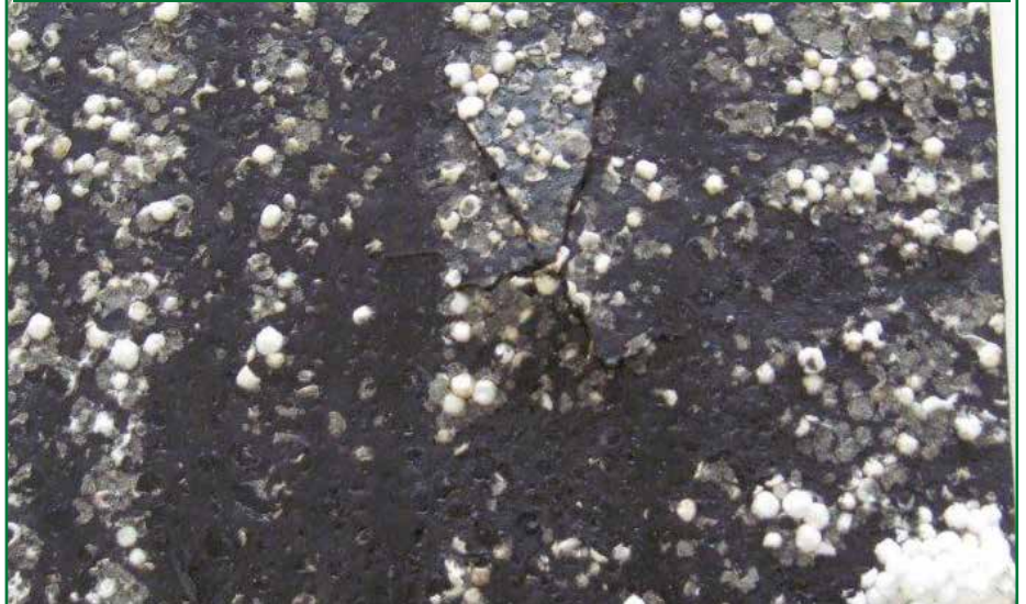
FACCIA INFERIORE CON ROTTURA A "STELLA"
