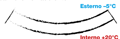
Deformazione invernale di un pannello non aderente
